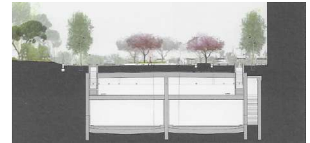
Sección transversal soterramiento Av Portugal
